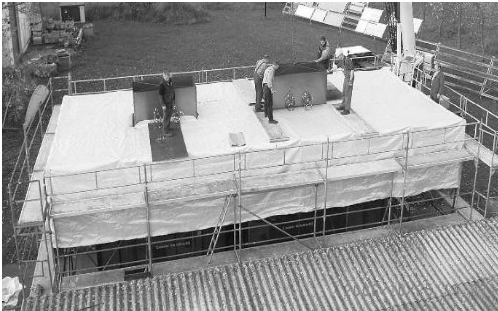
Bild 6 Rauchgassammelhaube im Experiment
