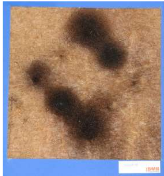
Bild 9 Thermische Zersetzung auf der Dämmstoffoberfläche bei durchgehenden Schrauben
