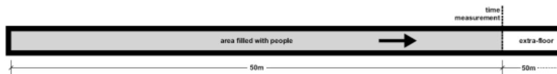
Bild 7 Szenario der Räumung eines 50 m langen und 2 m breiten Ganges unterschiedlicher Anfangspersonendichten [44]
