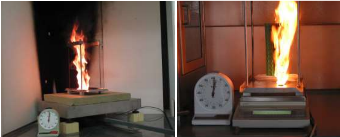
Bild 4 Abbrand von Plastikspielzeugplatte mit Aufzeichnung des Masseverlustes und Verwendung der Analytik der Single Burning Item Messapparatur
