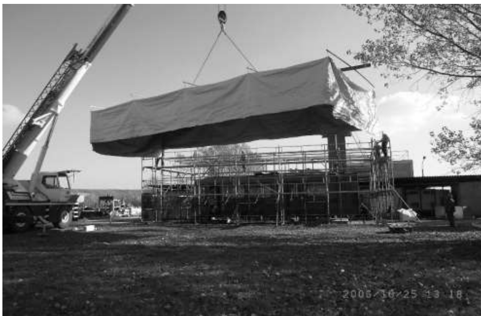
Bild 4 Übersicht des Versuchszustandes für den Brandversuch an einem Stadtbahnwagen der Essener Verkehrs AG auf dem Gelände der MFPA in Leipzig
