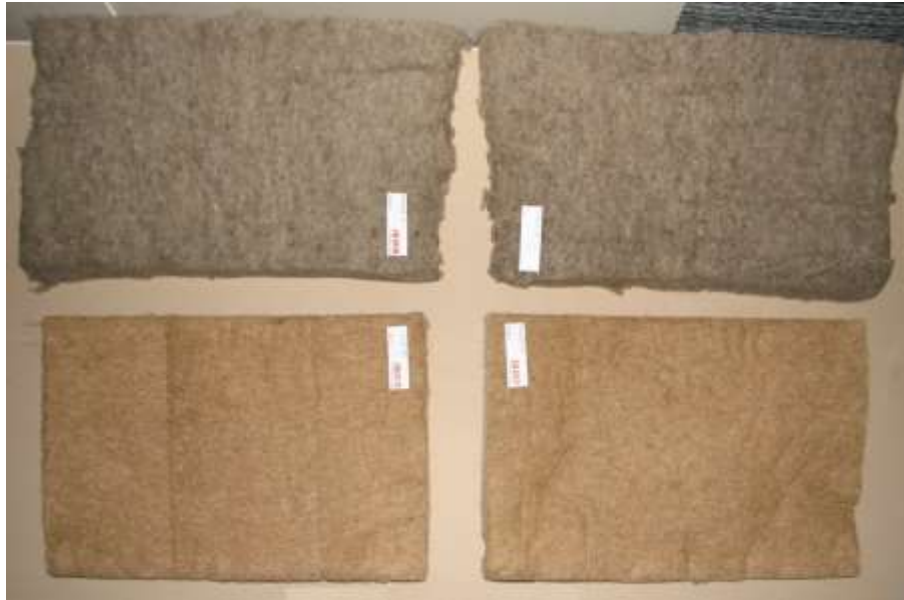
Bild 10 Dämmstoffoberflächen nach 60-minütigem Normbrand
