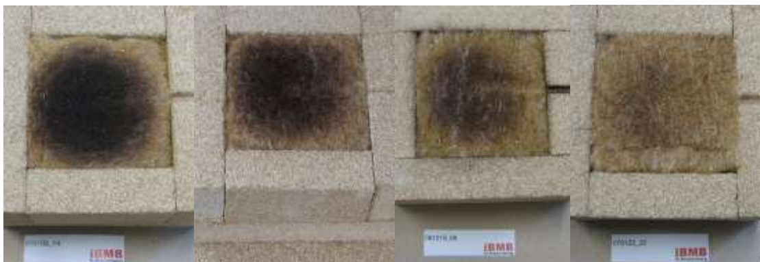
Bild 4 Dämmstoffoberfläche nach Erreichen von 275°C, 250°C 225°C und 200°C im Cone-Kalorimeter
