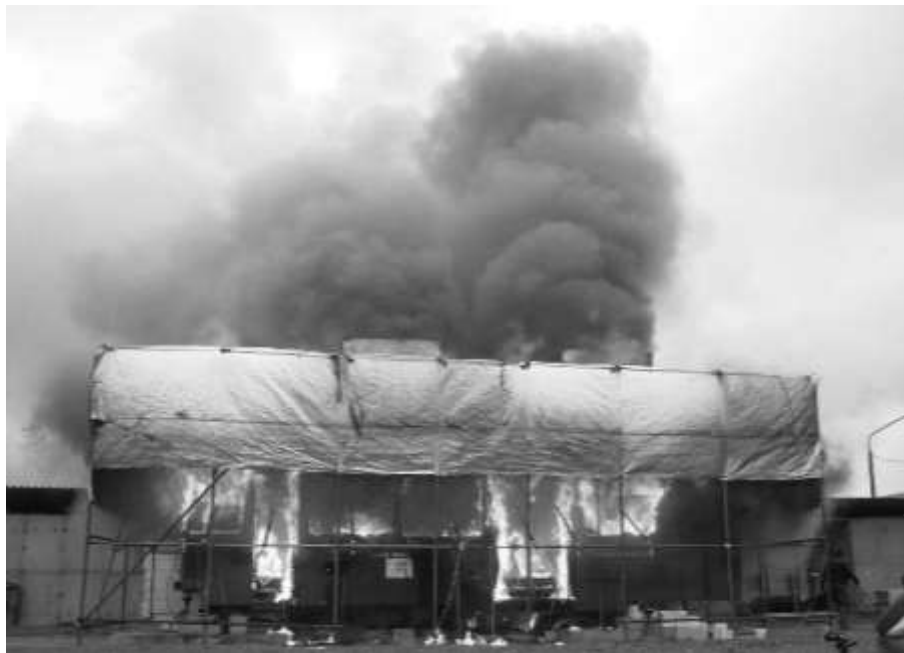
Bild 9 Vollbrand der Stadtbahn im Experiment
