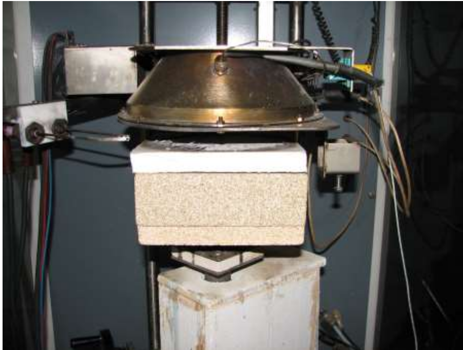
Bild 3 Probekörper im Cone-Kalorimeter
