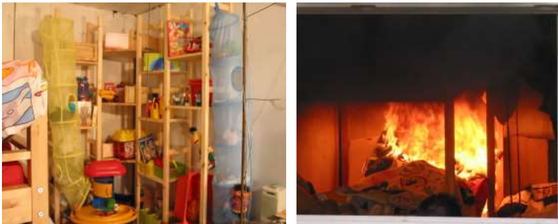
Bild 1 Großbrandversuch in einem Kinderzimmer
