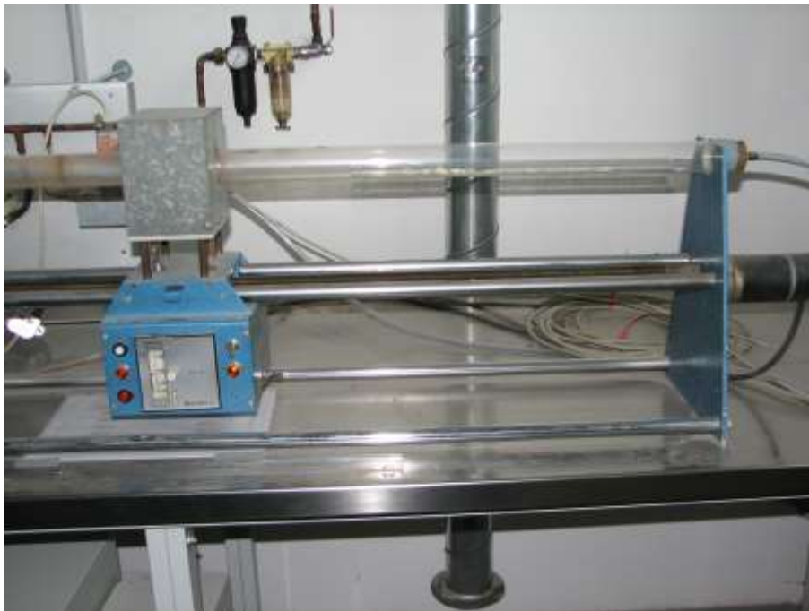
Bild 5 Prüfaufbau zur Bestimmung der Rauchgasentwicklung
