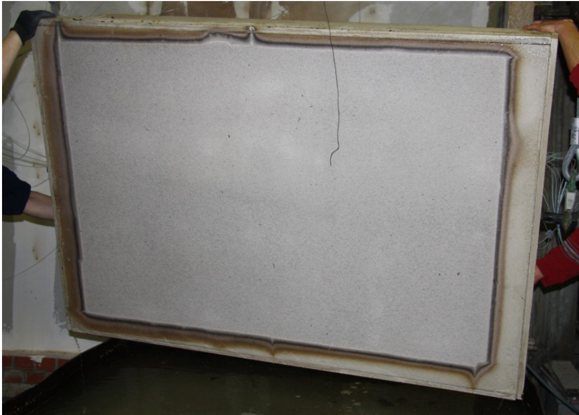
Bild 18 Zustand des Putzes nach dem Brandversuch
