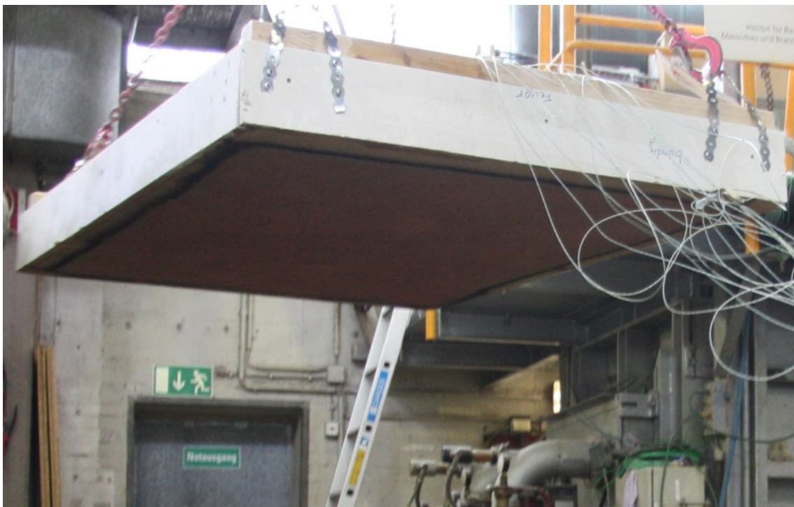
Bild 14 Lehm-Putzschicht nach 60-minütiger ETK-Beflammung
