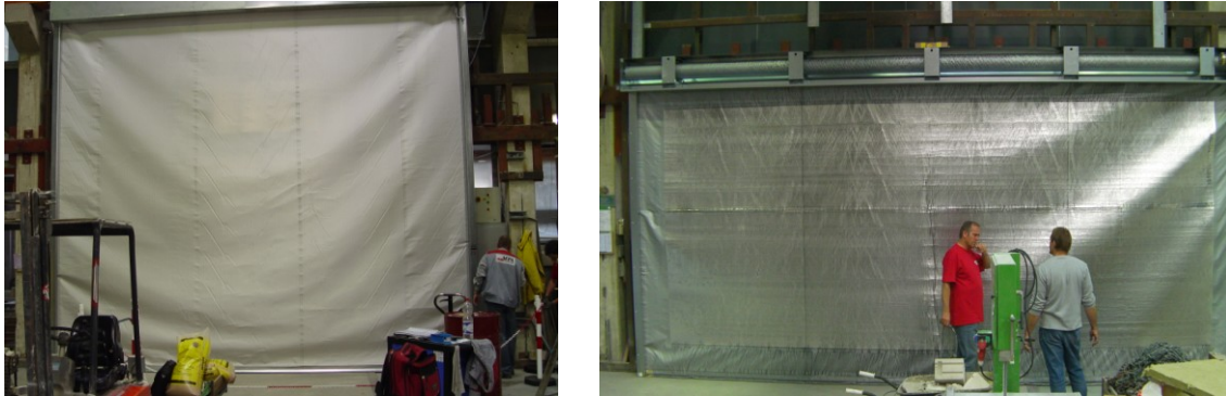
Bild 8 Dauerfunktionsprüfungen an textilen Feuerschutzabschlüssen
