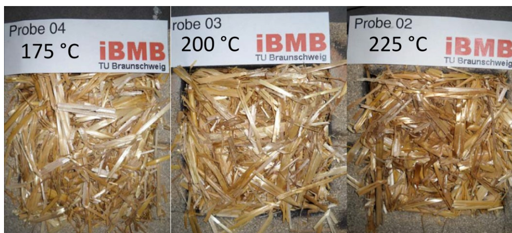
Bild 12 Bestimmung der Grenztemperatur der thermischen Zersetzung [15]
