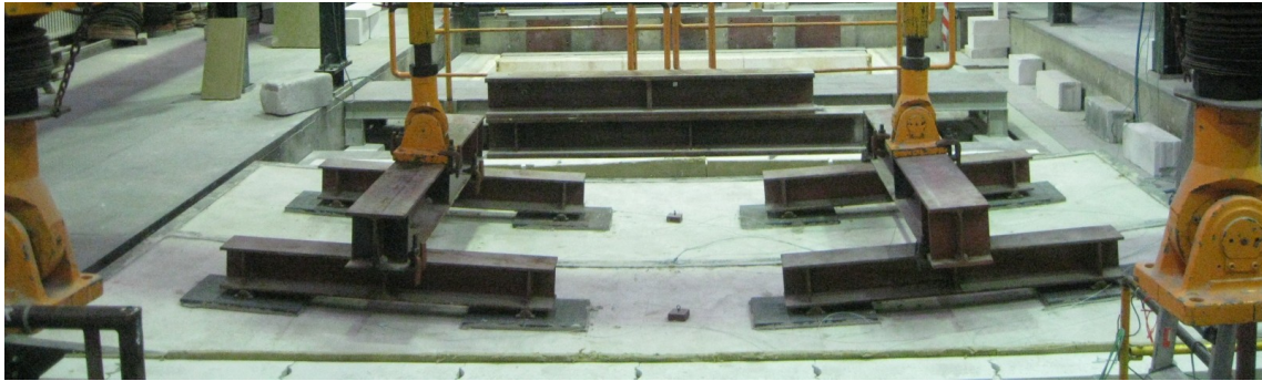
Bild 7 Lasteinleitung während einer Brandprüfung an der „Kleineschen Decke“ ohne Bekleidung auf der Unterseite der Decke
