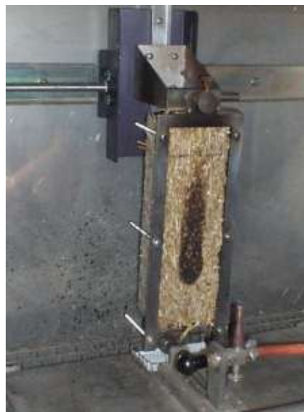
Bild 3 Durchführung eines B2-Versuchs im Kleimbrennertest [3]
