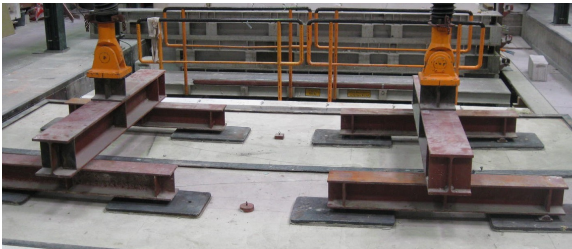
Bild 6 Lasteinleitung während einer Brandprüfung an der „Kleineschen Decke“
