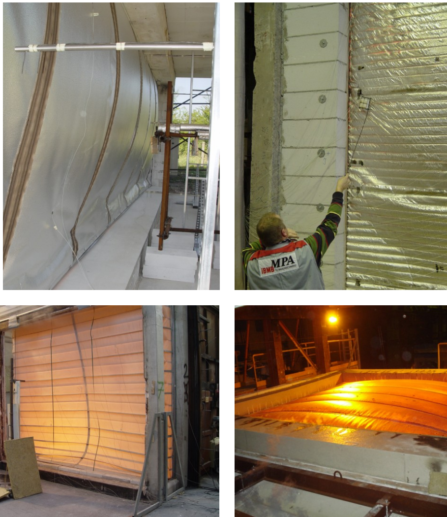
Bild 7 Beispiele von Brandprüfungen mit textilen Feuerschutzabschlüssen
