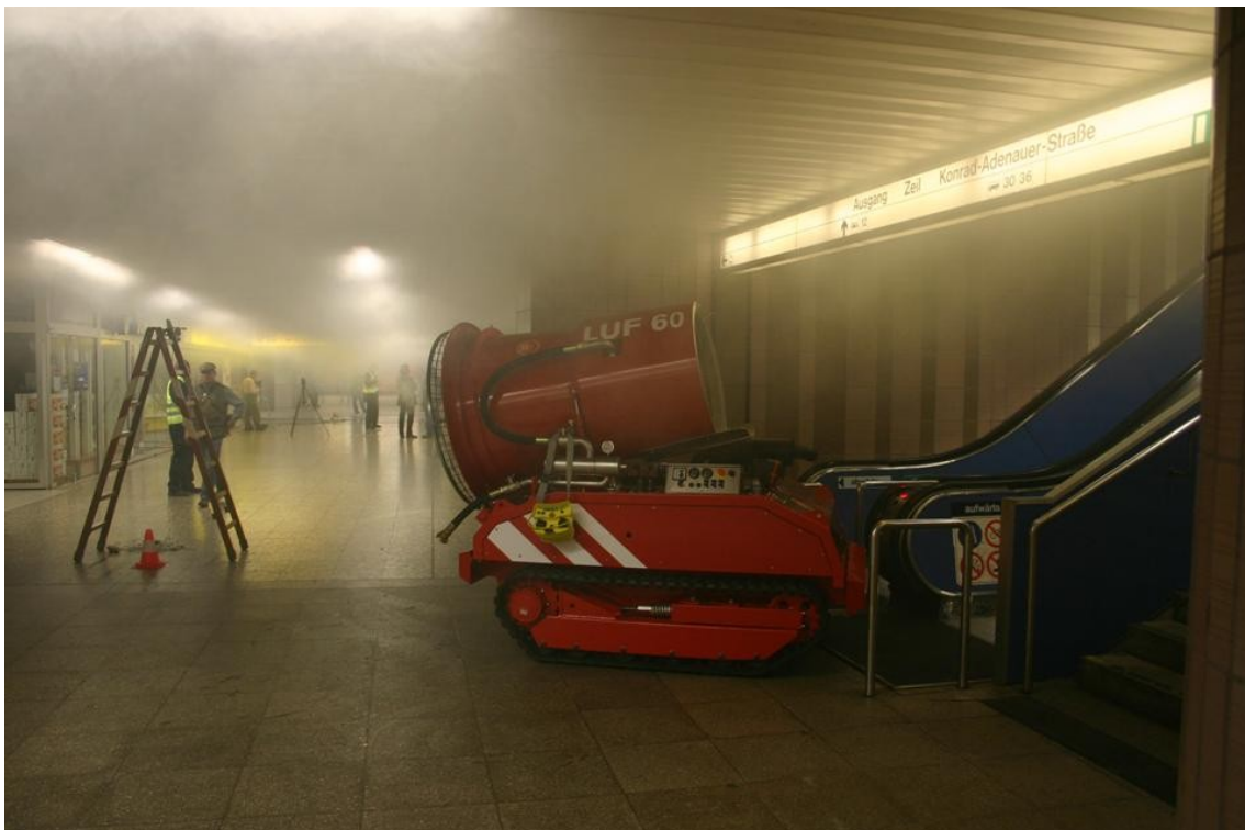
Bild 1 Einsatz von Lüftergeräten bei der Verrauchung des U-Bahnhofs Konstabler Wache in Frankfurt am Main
